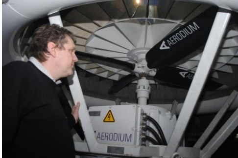
Sous le plateau de Forest national, la turbine qui permet à Peter Pan de voler « pour du vrai ».
